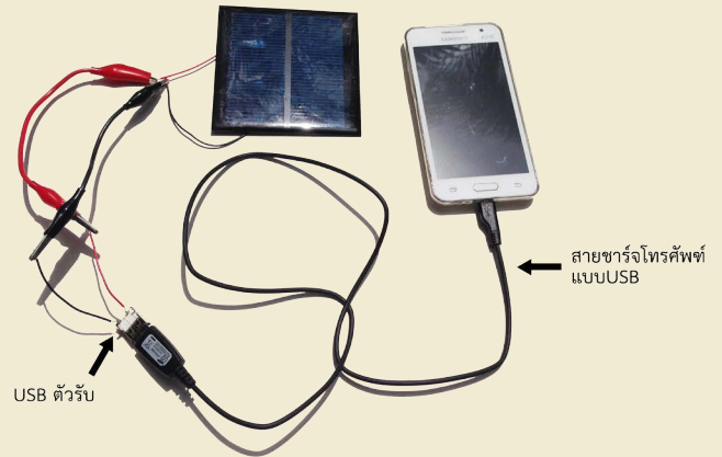
ภาพที่ 2 การเชื่อมต่อเซลล์แสงอาทิตย์กับสายชาร์จโทรศัพท์เคลื่อนที่แบบ USB เพื่อชาร์จแบตเตอรี่
