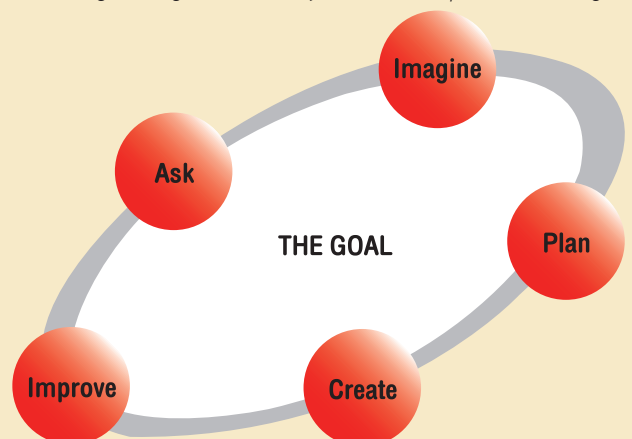
แผนภาพ วงจรกระบวนการออกแบบเชิงวิศวกรรม ของ Engineering is Elementary, UK (ที่มา: http://www.eie.org/ )
